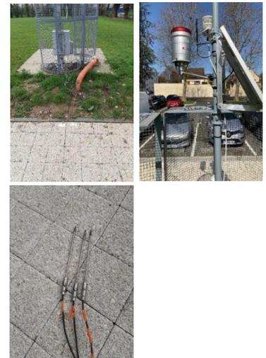
**Nos résultats** – Les revêtements composés de pavés à base de coquilles Saint-Jacques témoignent d’un comportement thermique favorable significatif durant un épisode de canicule. Les résultats observés pour le béton imperméable confirment sa contribution à l’échauffement de l’air ambiant. Les analyses menées mettent en évidence les implications distinctes du revêtement de surface et de la fondation dans les propriétés climatiques des systèmes de sols.
